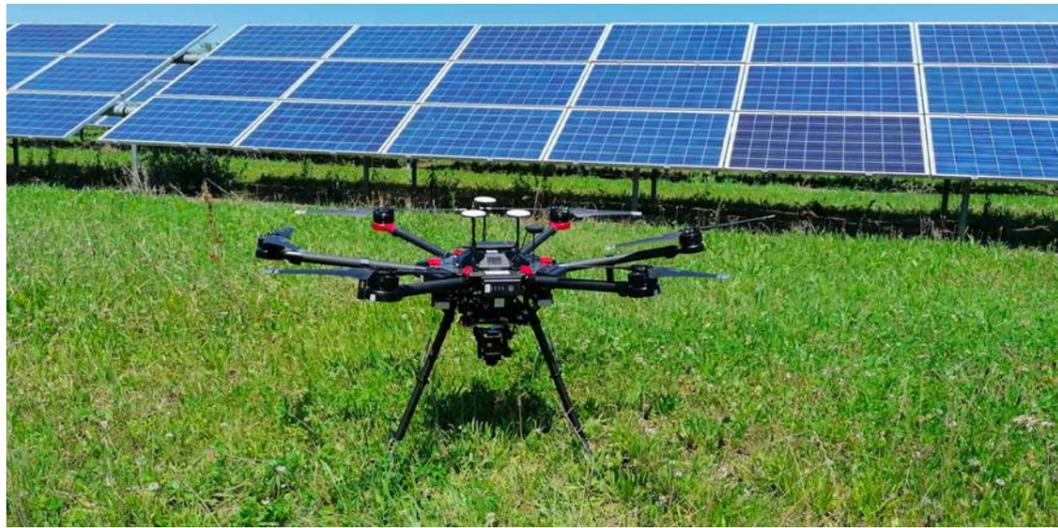
NEL 2019 ESAPRO HOLDING HA ACQUISITO ARCHETIPO, SOCIETÀ VENETA CHE OFFRE SERVIZI DI INGEGNERIA TRA I QUALI LE ANALISI TERMOGRAFICHE DI IMPIANTI FOTOVOLTAICI TRAMITE AEROMOBILI A PILOTAGGIO REMOTO
